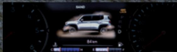
**MUD / SAND** Das System nutzt den elektrischen Allradantrieb für mehr Drehmoment und Traktion bei niedrigen Geschwindigkeiten. Dank spezieller Fahrwerksteuerung, genau abgestimmter Differenziale und präziser Übersetzungsverhältnisse behauptet sich der Wagen auf sandigem und schlammigem Untergrund.
