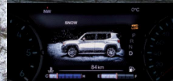
**SNOW** Bietet zusätzliche Stabilität und minimiert das Übersteuern für mehr Sicherheit und Leistung auf schnee- und eisbedeckten Strassen. Für ein ausgewogenes Fahrerlebnis werden verschiedene Fahrzeugsysteme automatisch gesteuert.
