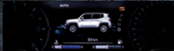
**AUTO** Der Standardmodus, der für alltägliches Fahren optimiert ist. Hier wird bei Bedarf der Elektromotor zugeschaltet, um den elektrischen Allradantrieb zu aktivieren.
