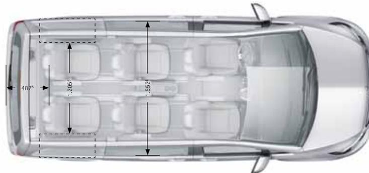
Alle Angaben in mm. Die genannten Maße sind Mittelwerte. Sie gelten für Fahrzeuge in Grundausstattung und in unbelastetem Zustand. <sup>1</sup> Fahrzeughöhe i. V. m. Sonderausstattung Dachreling zusätzlich 48 mm. <sup>2</sup> Innenhöhe. <sup>3</sup> Unbeladen. <sup>4</sup> Maximale Breite des Fahrgastraums (am Boden gemessen). <sup>5</sup> Lichtes Maß zwischen den Radkästen. <sup>6</sup> Maß gemessen am Fahrzeugboden.
