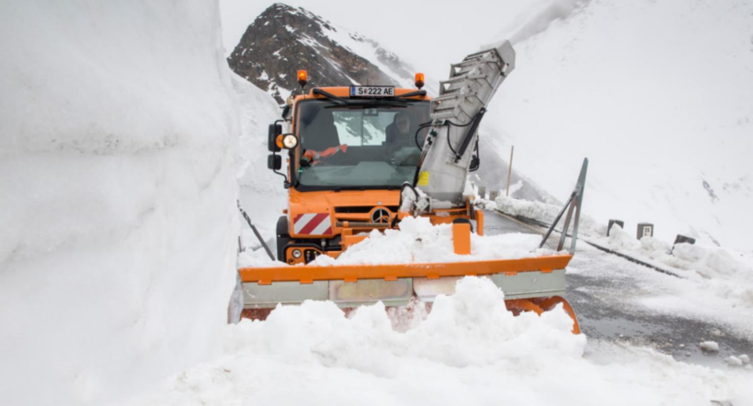
Egal wie alt und hart der Schnee ist: die starke mechanische Frontzapfwelle bietet genug Leistung für den Antrieb von Schneefräsen aller Art.
