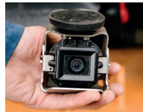
Die magnetische Rückfahrkamera kann flexibel positioniert werden und ermöglicht so die optimale Sicht nach hinten.
