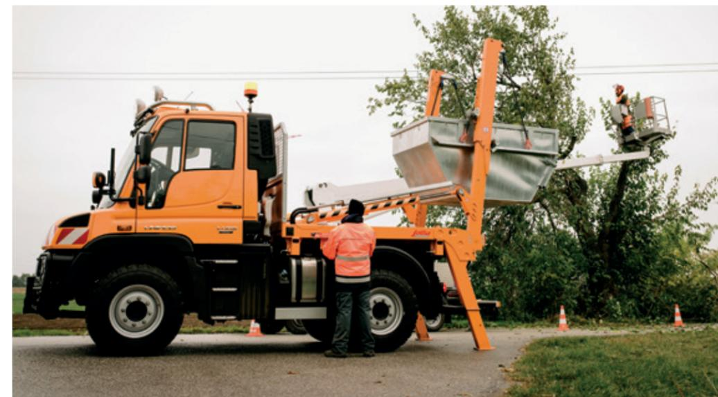
Durch die kompakten Abmessungen können die kleinen Container auch an schmalen Wegen oder engen Stellen abgesetzt werden.
